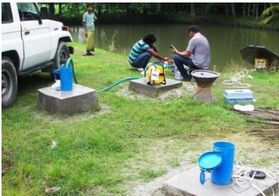
মাঠ পর্যায়ে ভূ-গর্ভস্থ পানি নমুনা সংগ্রহ ও একুইফার পাম্প টেস্ট হতে উপাত্ত সংগ্রহের চিত্র
