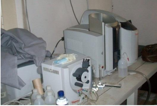
প্রকল্পের আওতায় পানি নমুনার রাসায়নিক বিশ্লেষণের জন্য সংগৃহীত Atomic Absorption Spectrometer এবং UV-VIS Spectro-Photometer
