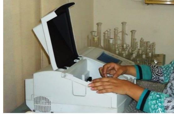
প্রকল্পের আওতায় পানি নমুনার রাসায়নিক বিশ্লেষণের জন্য সংগৃহীত Atomic Absorption Spectrometer এবং UV-VIS Spectro-Photometer
